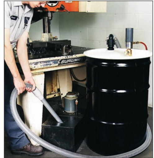
Die Dual Mode Transvektor-Vakuumpumpe zum Füllen (bis zu 112 l/min) und Entleeren (bis zu 170 l/min) von Fässern.
