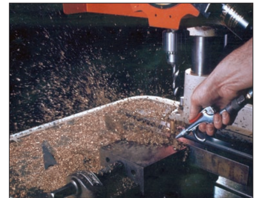
Die Blaspistole Modell 9401BSP ist mit einer geräuscharmen, luftsparenden Düse ausgerüstet.
